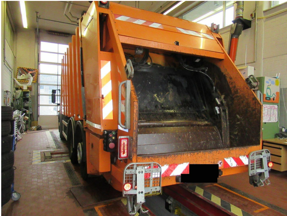
Bild 9 : Müllpresse ausgeschlagen verschlissen ( zeitweise festhängend ohne Funktion, ohne Sicherheitsprüfung )
