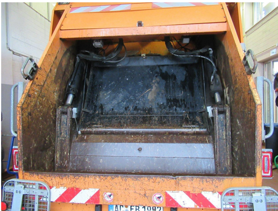
Bild 10 : Müllpresse ausgeschlagen verschlissen ( zeitweise festhängend ohne Funktion, ohne Sicherheitsprüfung )
