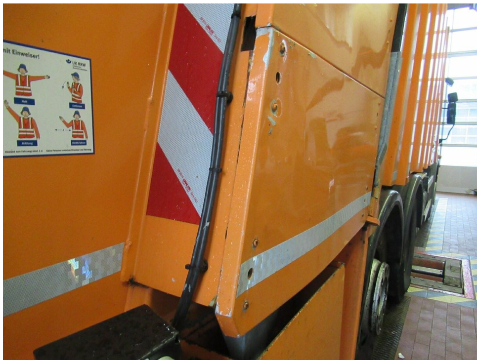
Bild 11 : Blende hr eingedellt verbogen
