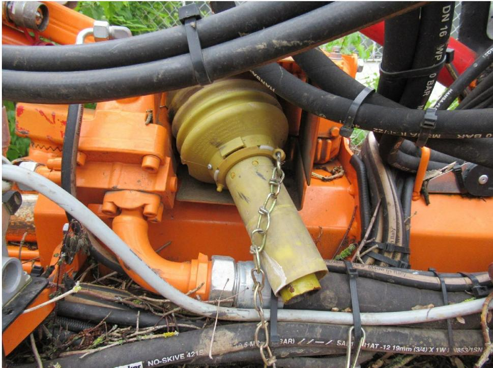
Bild 5 : Anschluß Zapfwelle
