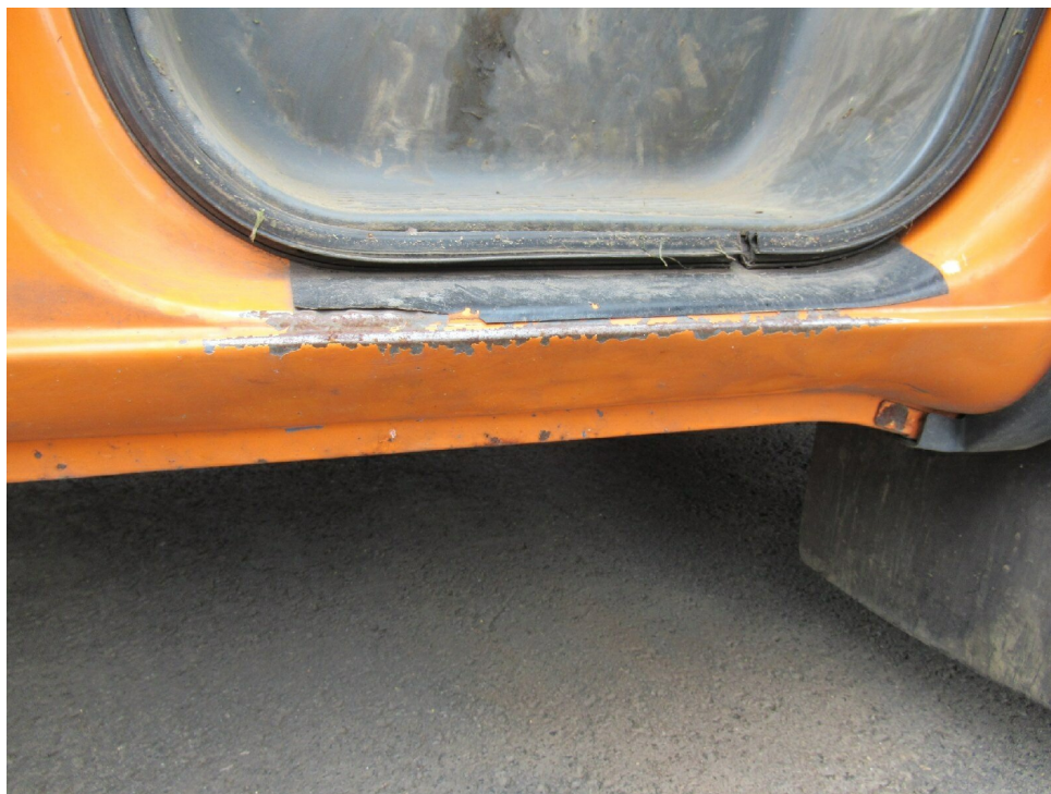
Bild 9 : Schweller r eingedellt, verrostet
