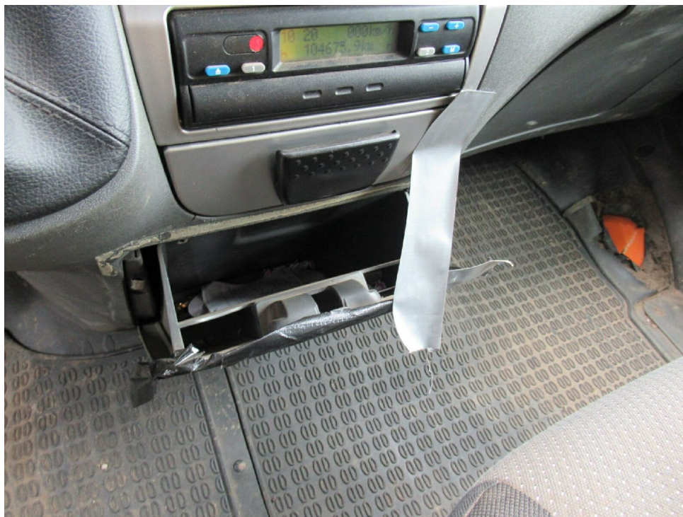
Bild 12 : Ablage Armaturentafel lose
