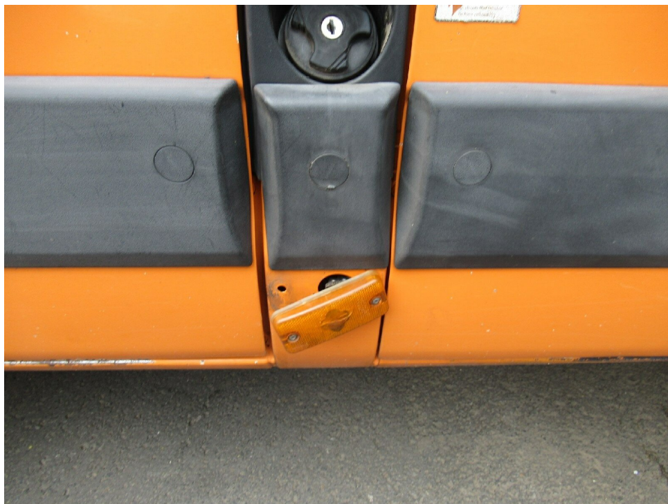
Bild 11 : Positionsluchte vl teilweise abgerissen
