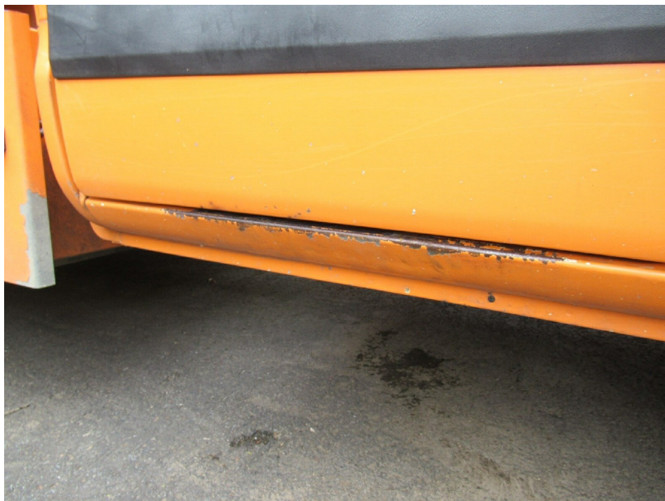
Bild 10 : Rostansatz am Schweller I
