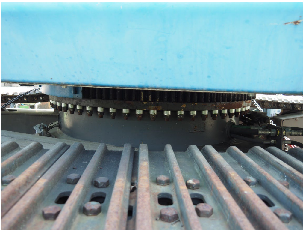
Abbildung 16 Oberwagen Verformung Foto
