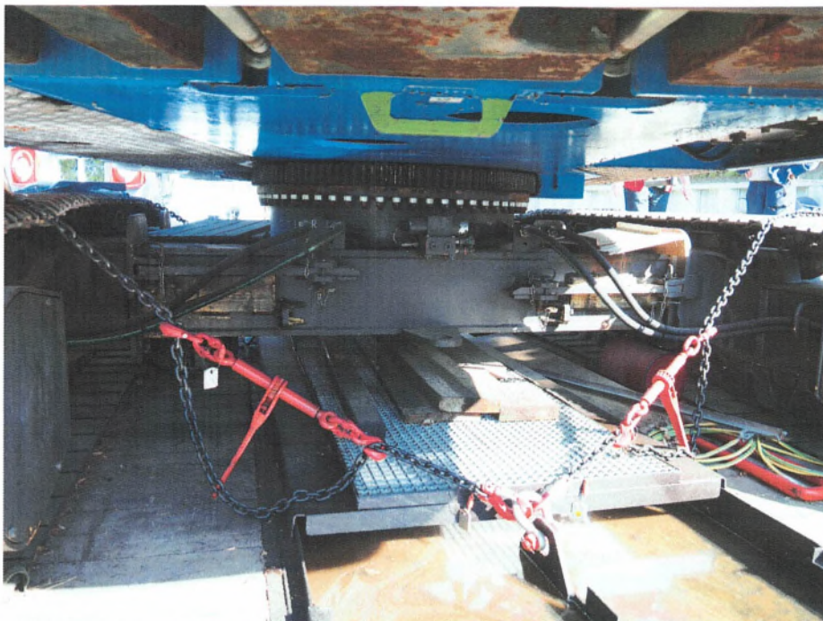
Abbildung 3 Unterwagen Abspannung nach Havarie 2022
