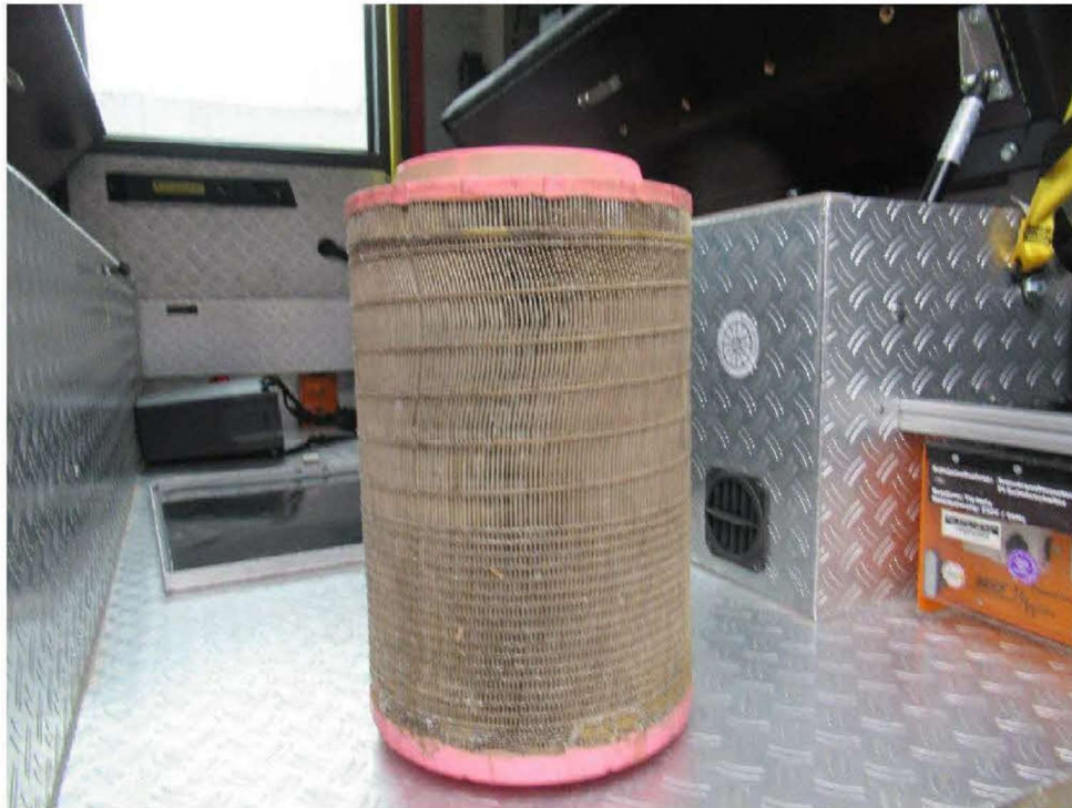
Bild 11 : zeigt den mit Wasser durchsetzten Luftfilter
