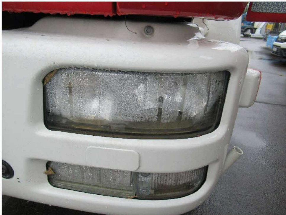
Bild 18 : zeigt die mit Wasser gefüllte Beleuchtungsanlage
