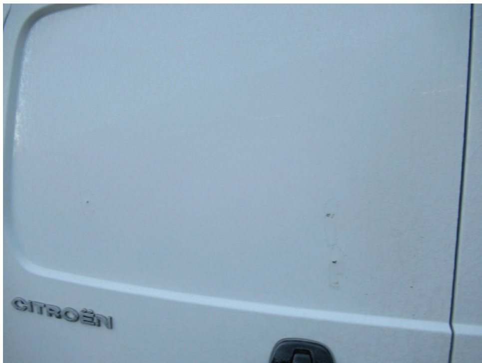
Bild 8 : Heckklappe | Beulen und Lackabplatzer
