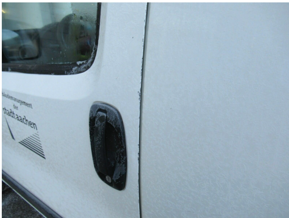
Bild 9 : Tür vl Kannte h eingedellt, verschrammt
