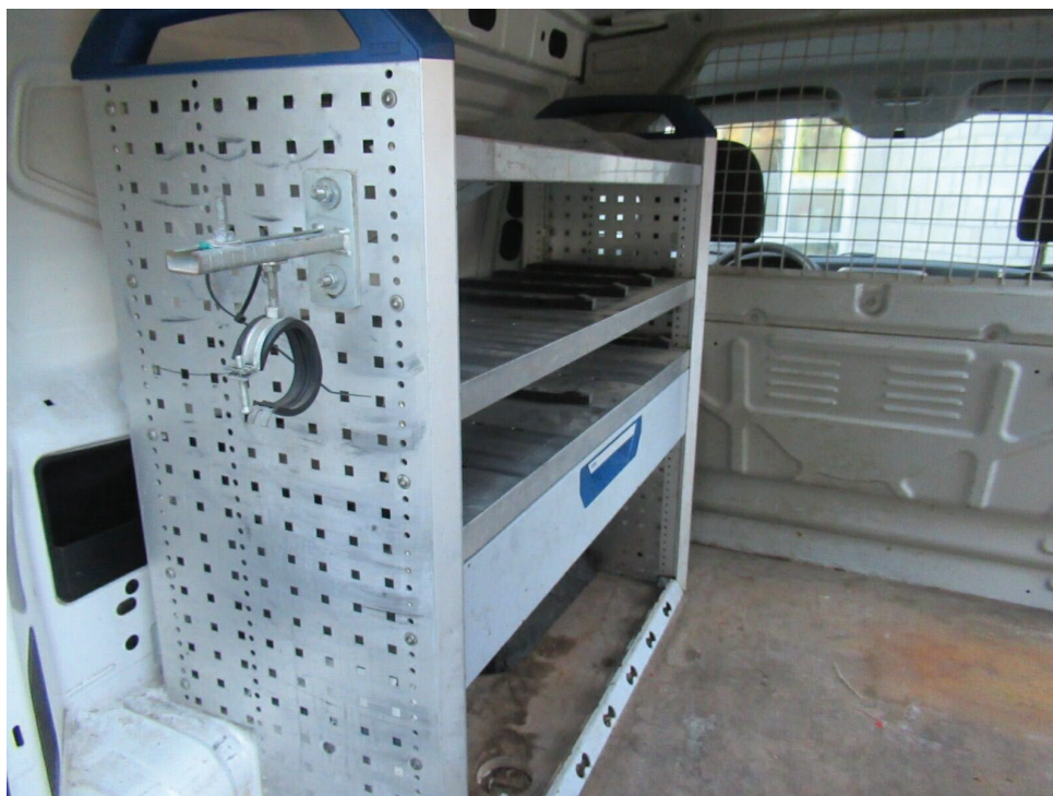
Bild 5 : Regalsystem im Laderaum
