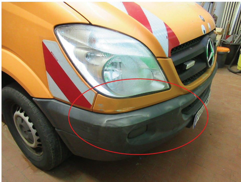
Bild 6 : Grillblende v und Stoßfängerverkleidung v verschrammt
