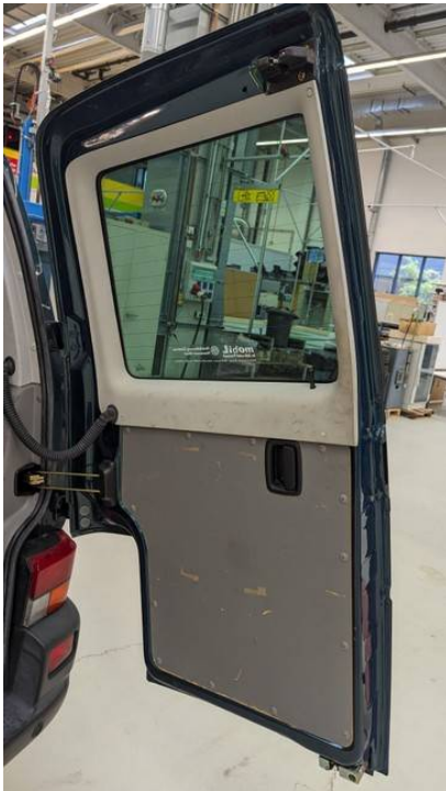
Verkleidung der Kofferraumtür rechts verkratzt und verschmutzt
