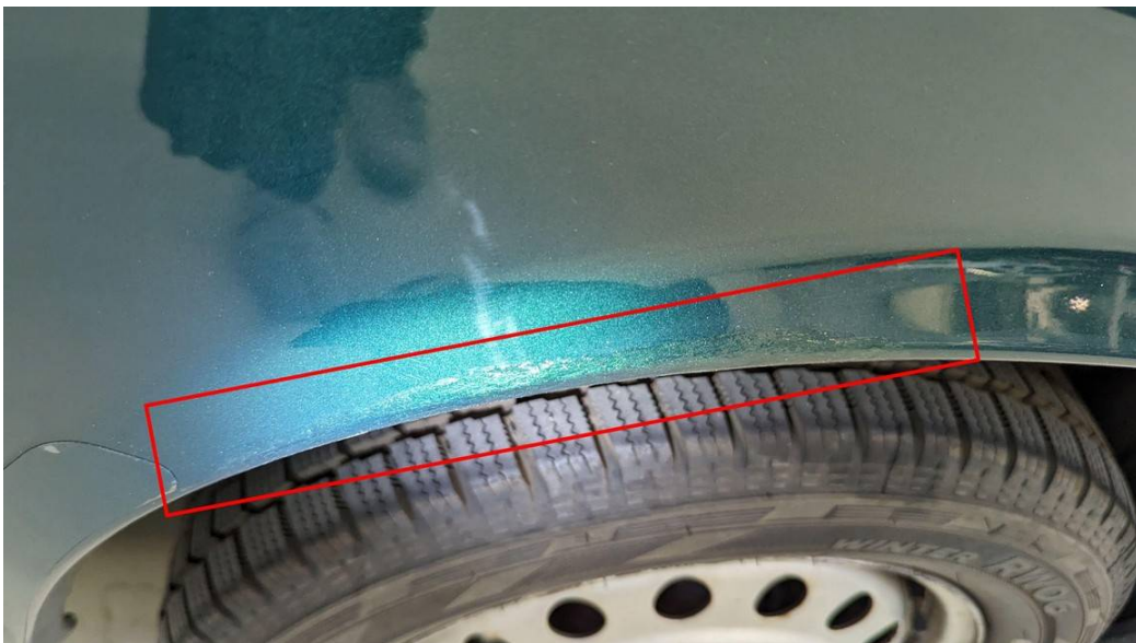
Seitenwand hinten links verschürft
