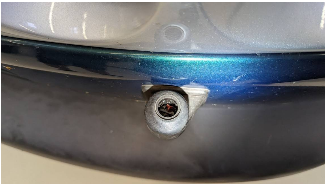
SRA Sprühdüse Fahrerseite beschädigt, ohne Funktion
