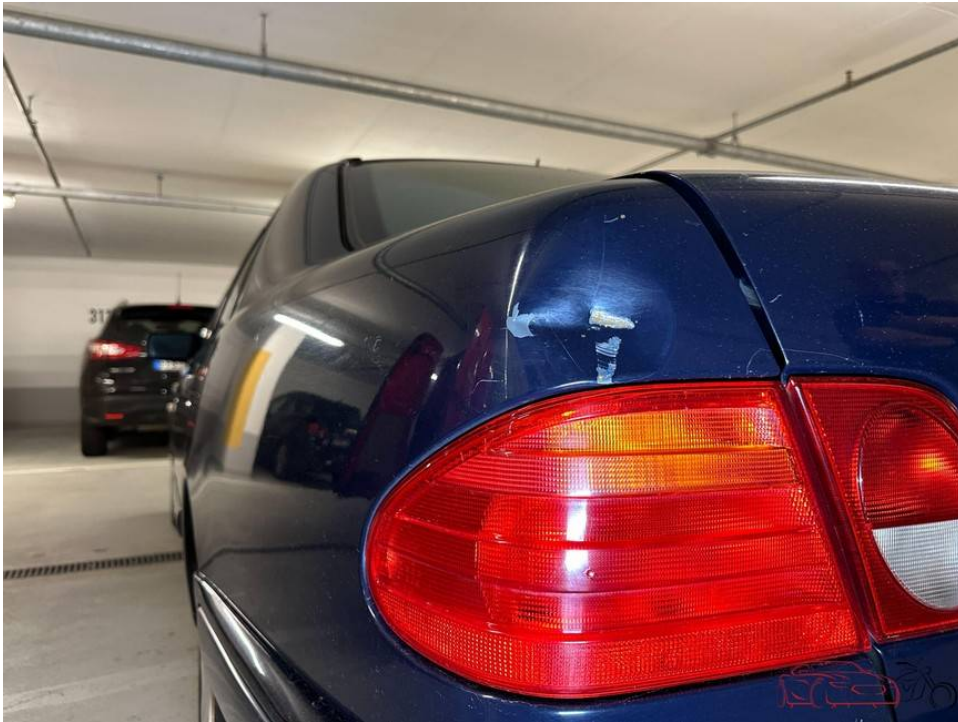
Seitenwand hinten links eingedrückt
