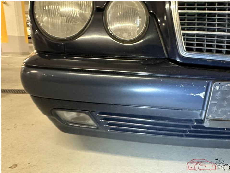
Lackabplatzungen Stoßleiste vorne rechts
