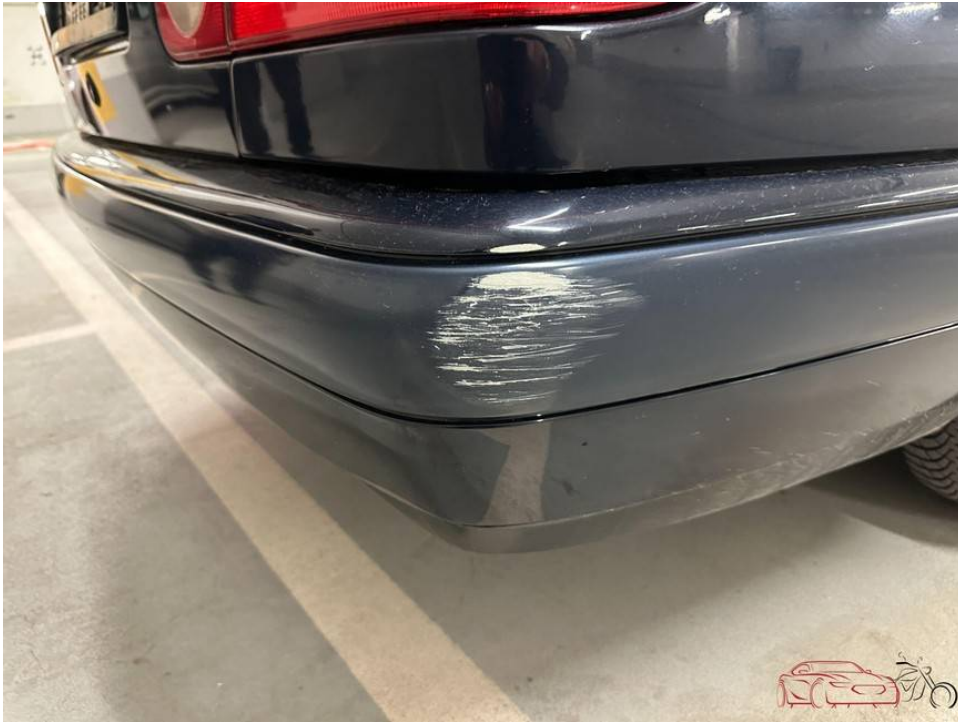
Lackkratzer hintere Stoßfängerverkleidung hinten rechts und Stoßleiste hinten rechts
