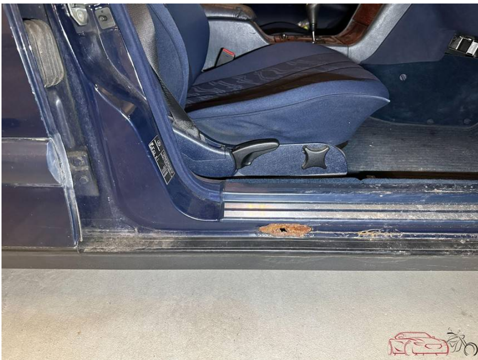
Schweller rechts durchgerostet
