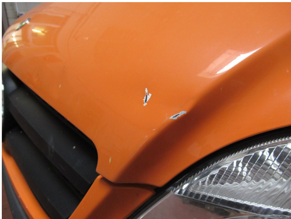
Bild 9 : Motorhaube Dellen, Lackschäden
