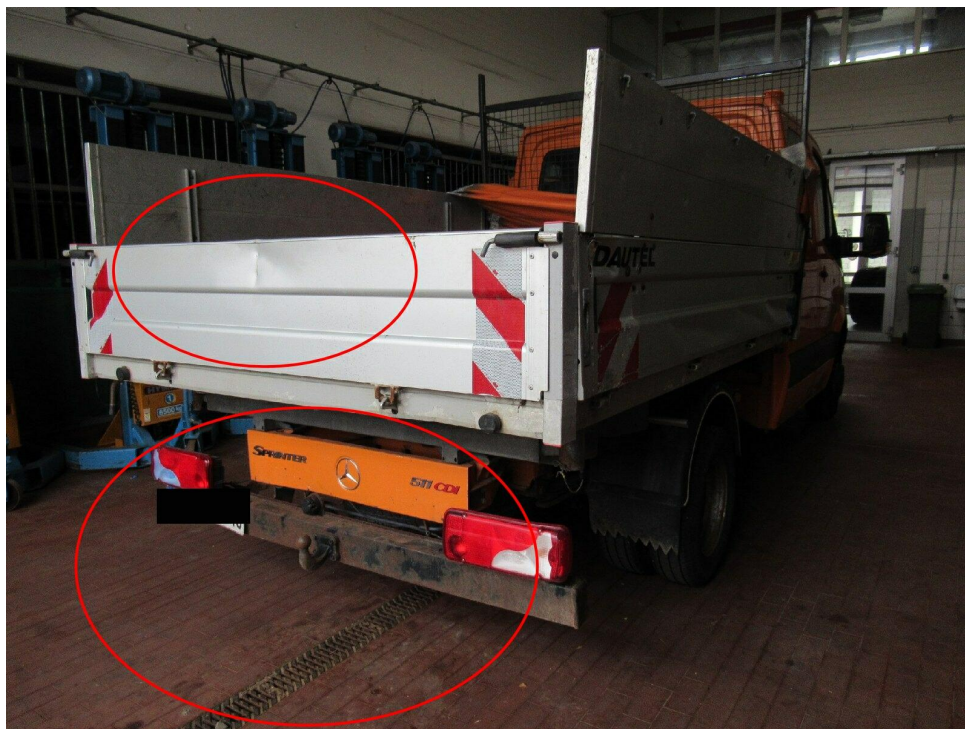
Bild 5 : Ladebordwand h eingedellt geknickt Rahmen und Hecktraverse starker Rostansatz
