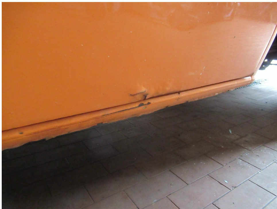
Bild 10 : Türen hl und hr unterhalb Rostansatz
