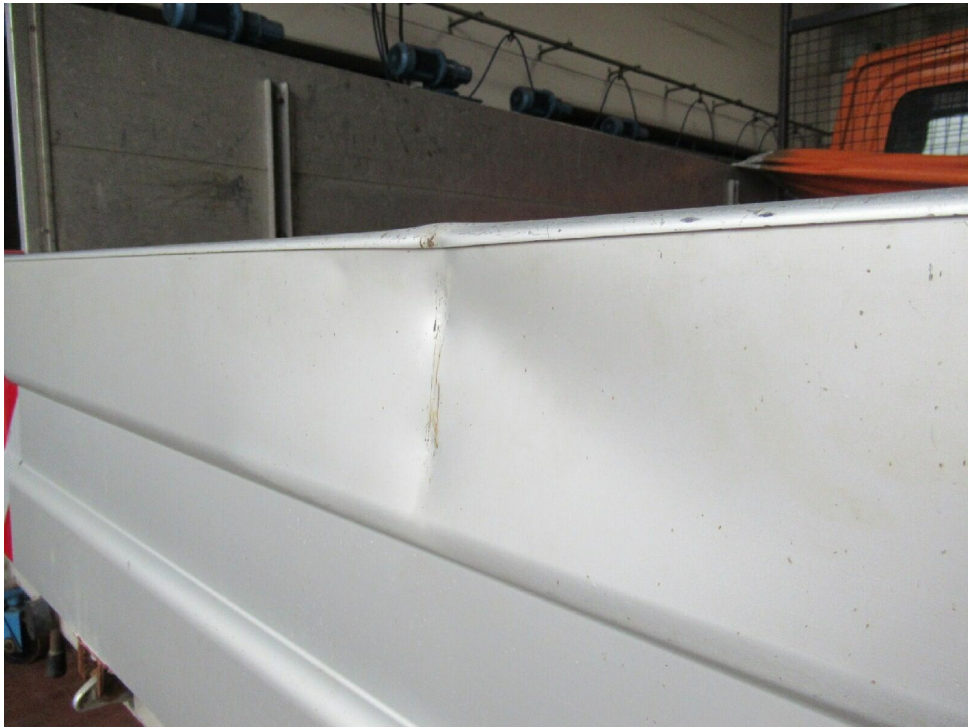
Bild 7 : Ladebordwand h eingedellt geknickt
