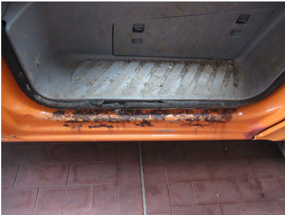
Bild 14 : Einstieg rechts Rostansatz
