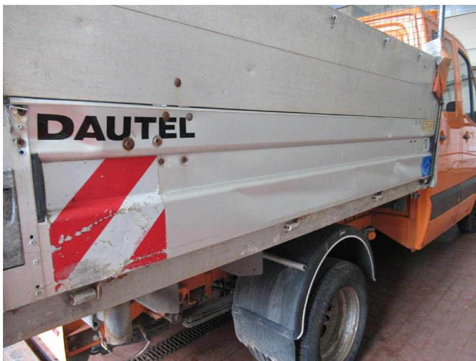
Bild 6 : Laderbordwand r mehrfach eingedellt, verbogen
