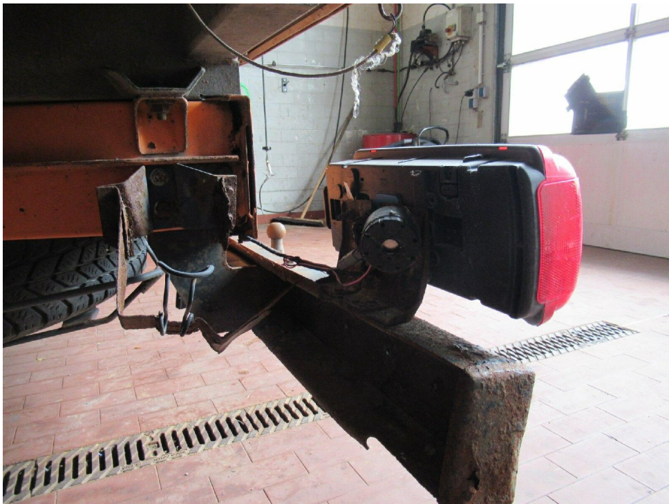
Bild 8 : Rahmen und Hecktraverse starker Rostansatz
