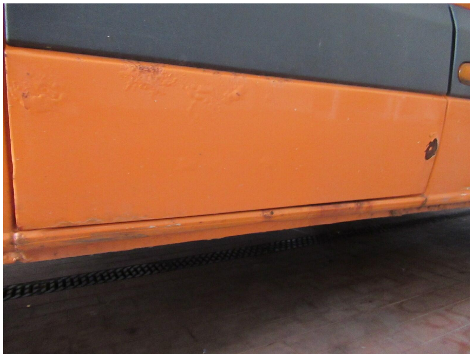
Bild 12 : Türen hl und hr unterhalb Rostansatz
