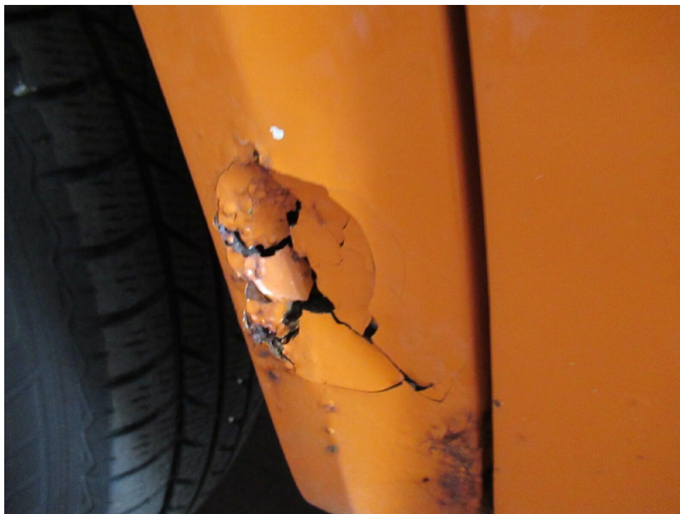
Bild 11 : Radlaufkniestück vl durchgerostet
