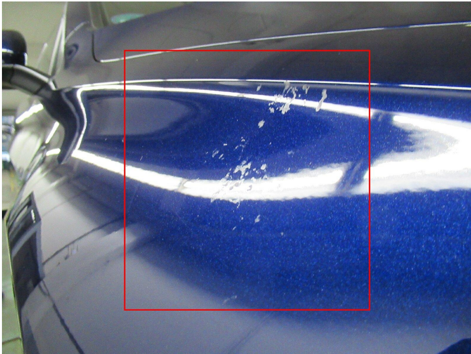
Bild 13 : Kotflügel rechts Flecken- / Umweltschäden
