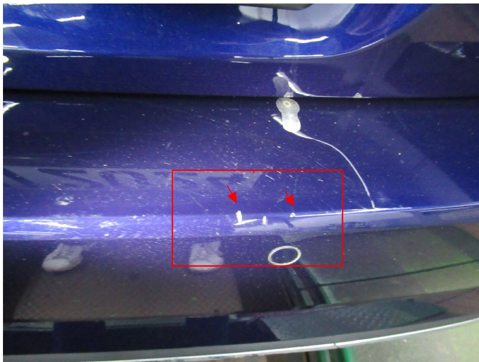
Bild 11 : Stoßfänger hinten, Ladekante Kratzer
