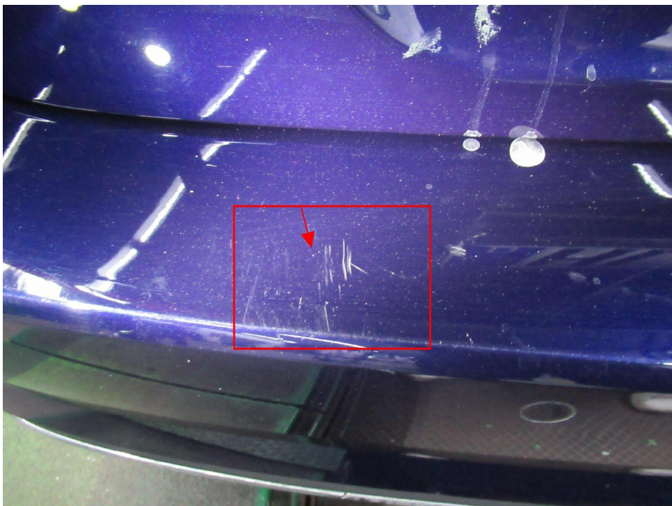
Bild 10 : Stoßfänger hinten, Ladekante Kratzer
