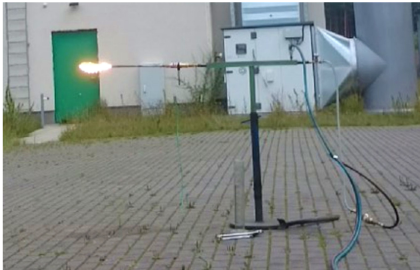
Abbildung 3: Prüfrohr und Brennröhr während einer Prüfung
