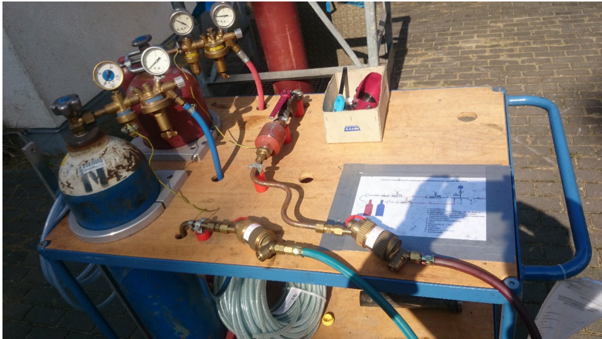
Abbildung 4: mobiler Wagen mit Gasversorgung (Acetylen/Sauerstoff) und Sicherheitseinrichtungen ISO 5175-1
