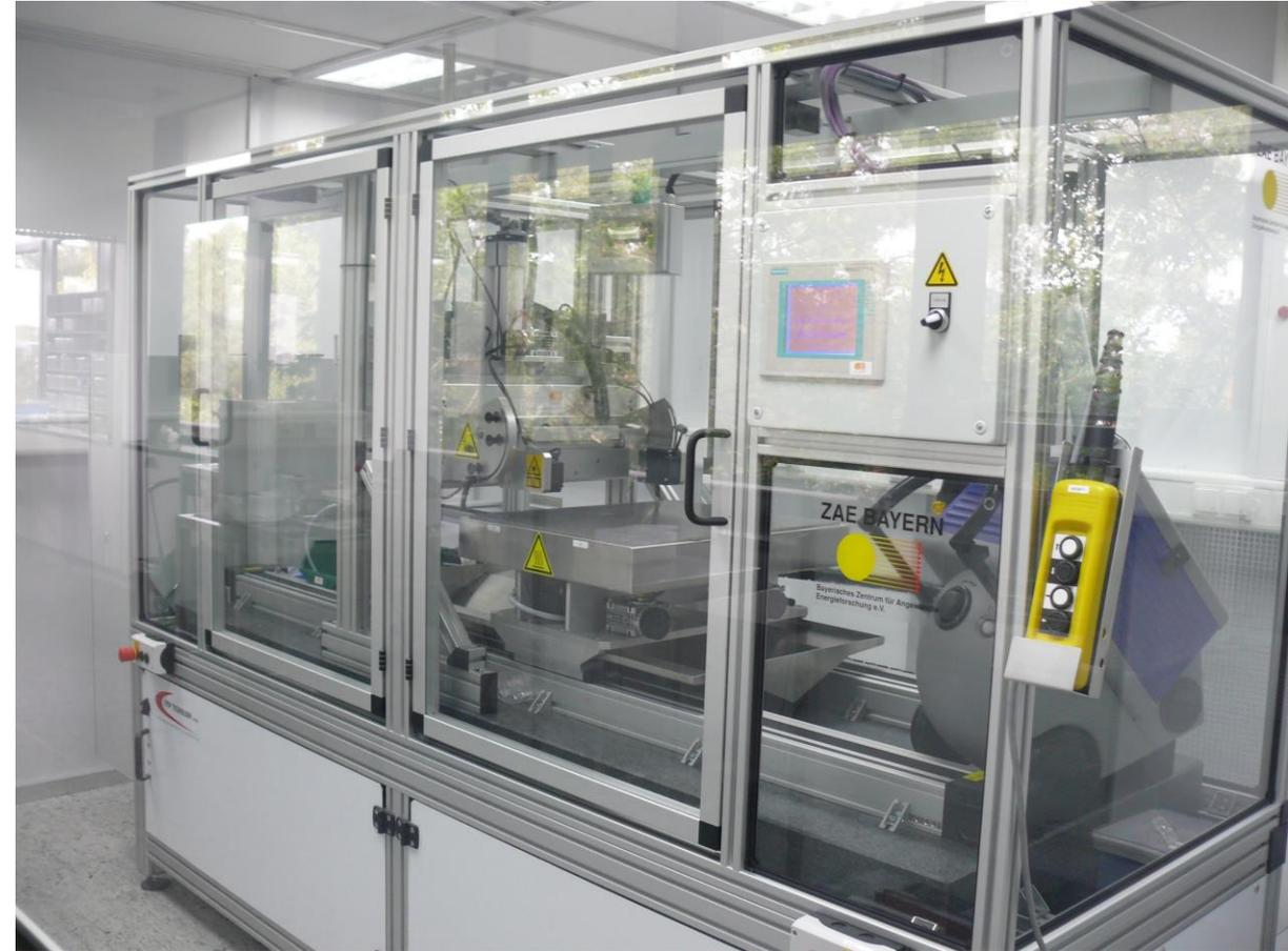
Beschichtungsmaschine für Glas und Folien
