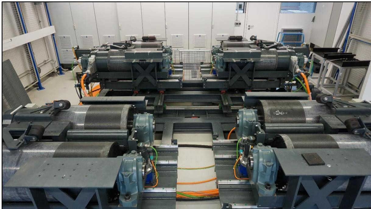
Bild 1: Fahrdynamikprüfstand in Vorderansicht
