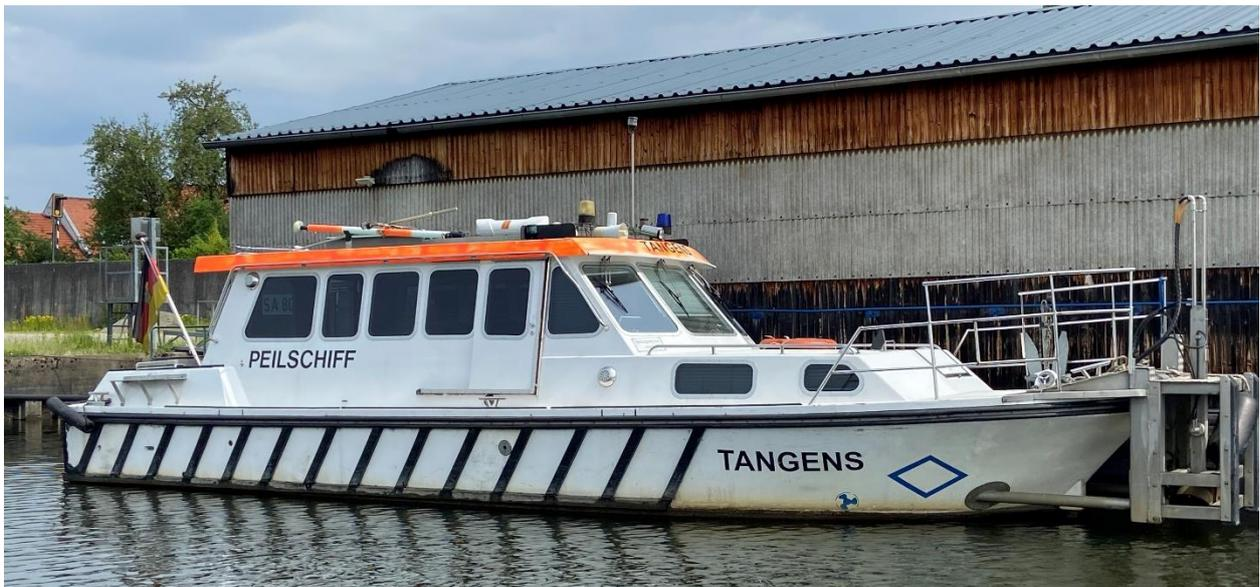
Das Peilschiff Tangens verfügt einen Rumpf aus GFK und Aufbauten aus Aluminium. Es wurde von der WSV (Wasserstraßen- und Schifffahrtsverwaltung des Bundes) durch das Wasserstraßen- und Schifffahrtsamt Donau MDK im Bereich des Main-Donau-Kanals für Vermessungen eingesetzt. Die Tangens entspricht der typischen Aufteilung eines Behördenfahrzeuges im Tagesdienst.
